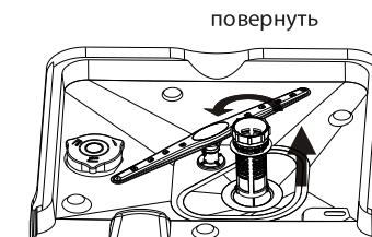
Шаг 1 - Поверните верхнюю часть блока фильтров против часовой стрелки
