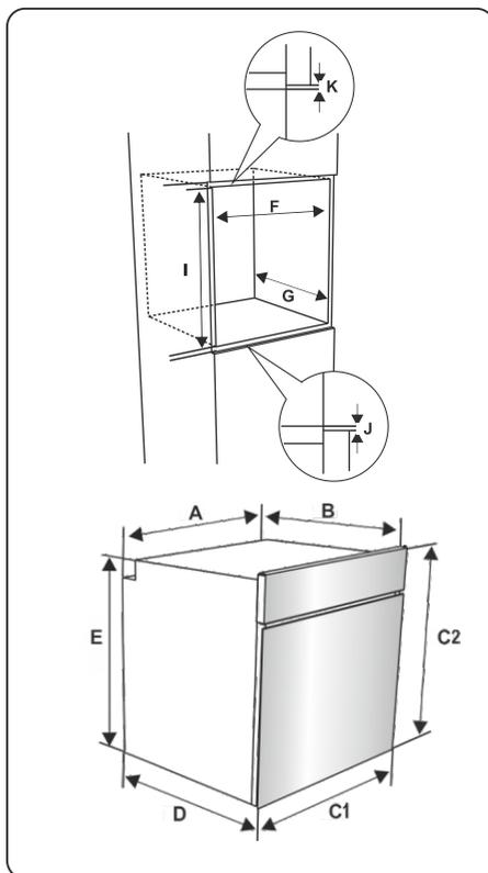
1. После подключения к электросети вставьте духовку в шкаф, продвигая ее от себя. Откройте дверь духового шкафа и вставьте два винта в отверстия, расположенные на раме духового шкафа. Убедившись, что рамка продукта соприкасается с деревянной поверхностью шкафа, затяните винты.
